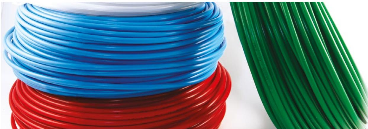
Il Polietilene a bassa densità può essere utilizzato in una gamma ristretta di temperature comprese tra i -40°C e +60°C. I tubi C.ECO in Polietilene per applicazioni dedicate alla pneumatica industriale vengono estrusi nel grado a bassa densità (**PE LD**).
