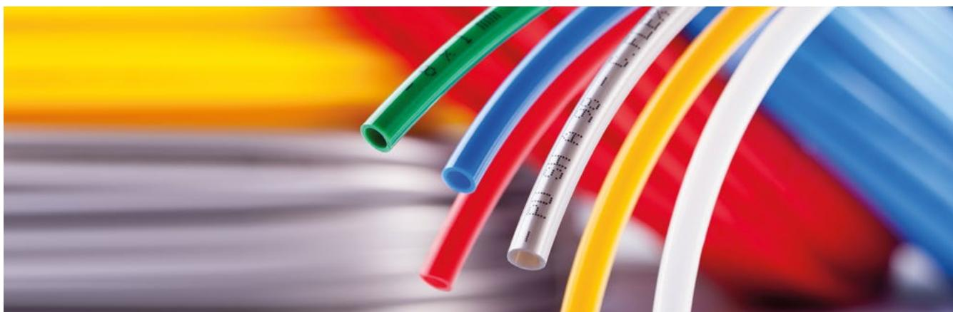
I tubi flessibili **C.FLEX 98** in poliuretano poliestere shore 98 A sono utilizzati nel 90% delle applicazioni della pneumatica industriale quando la pressione non supera 8 bar. Questi tubi sono apprezzati per la loro grande flessibilità, raggio di curvatura stretto e un'eccellente resistenza alla piegatura.
