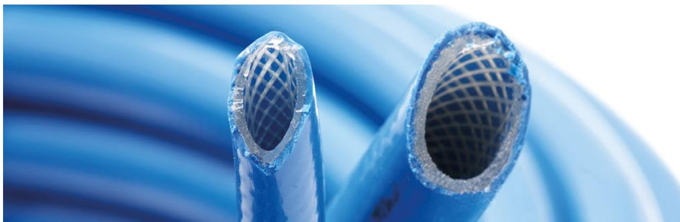
**C.TWENTY:** tubo in poliuretano retinato molto flessibile. Ha una buona resistenza all'abrasione, una flessibilità 5 volte superiore a quella del PVC e grazie alla retinatura in poliestere puo essere usato con pressioni di esercizio di 20 bar.
